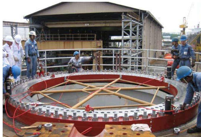
Bild 3: Paralleles Verschrauben: Die ITH-Schraubenspannzylinder an einem Großwälzwerk.
